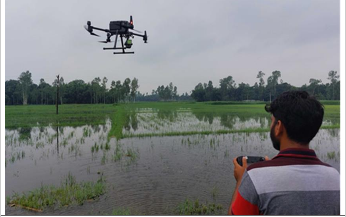
চিত্রঃ ০৬ প্রভাতী প্রকল্পের অধীনে গাইবান্ধা জেলায় LiDAR সেন্সার ও ড্রোন ব্যবহারের মাধ্যমে পরিচালিত ভূস্থানিক জরিপ।
